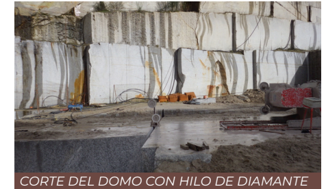
CORTE DEL DOMO CON HILO DE DIAMANTE
