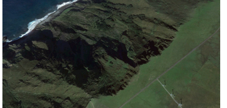
Borde del acantilado en las inmediaciones de Vixía Herbeira mordido por los deslizamientos circulares que afectan a todo el acantilado.
