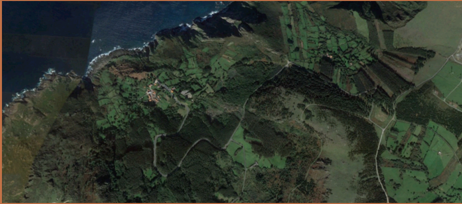
Situación del valle de Santo André de Teixido formado a favor de un deslizamiento múltiple circular. Cada zona cultivada corresponde a uno de los deslizamientos.
